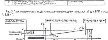
Рис. 4. План поверхности захода на посадку и переходных поверхностей для ВПП класса Д и Е.
